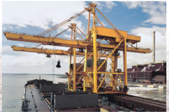
Zwei 40 t Greiferentlader
