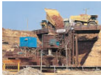
Semimobile „In-Pit Crushing“ Anlage
